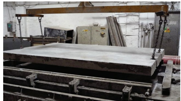
Beton mit PUR-Zuschlagstoffen [Václavík et al., 2012]
