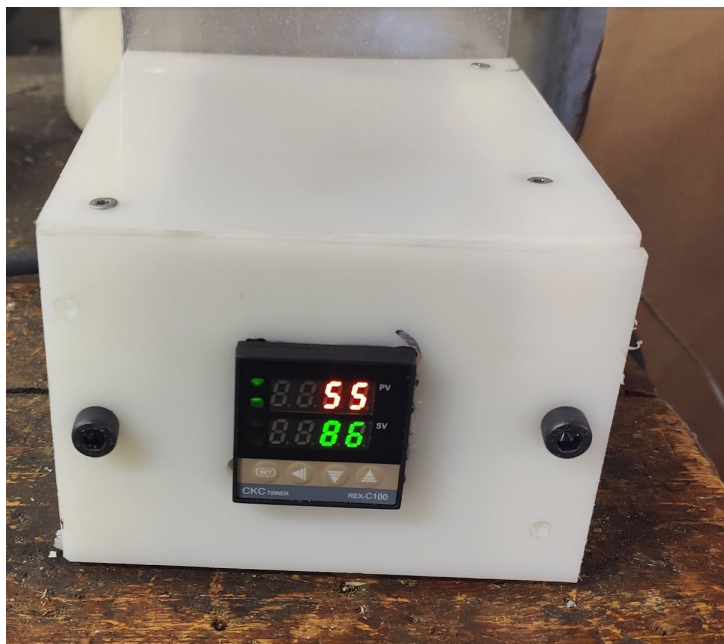
Figur 7: Foto af PID-regulatoren anvendt under testen, der viser aktuel temperatur (øverst) og ønsket temperatur (nederst).
