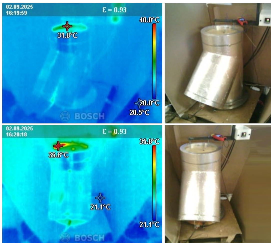
Figur 16: Termografi af testopstillingen samt tilsvarende billede i synligt lys.
