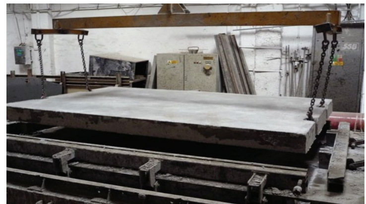
Beton med PUR granulat [Václavík et al., 2012]
